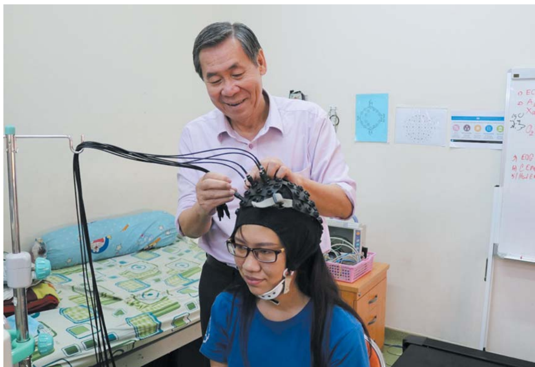
GS Võ Văn Tới hướng dẫn sinh viên thực hành với máy Functional Near-Infrared Spectroscopy (fNIRS). Ảnh: Phương Anh - Thu Trang
